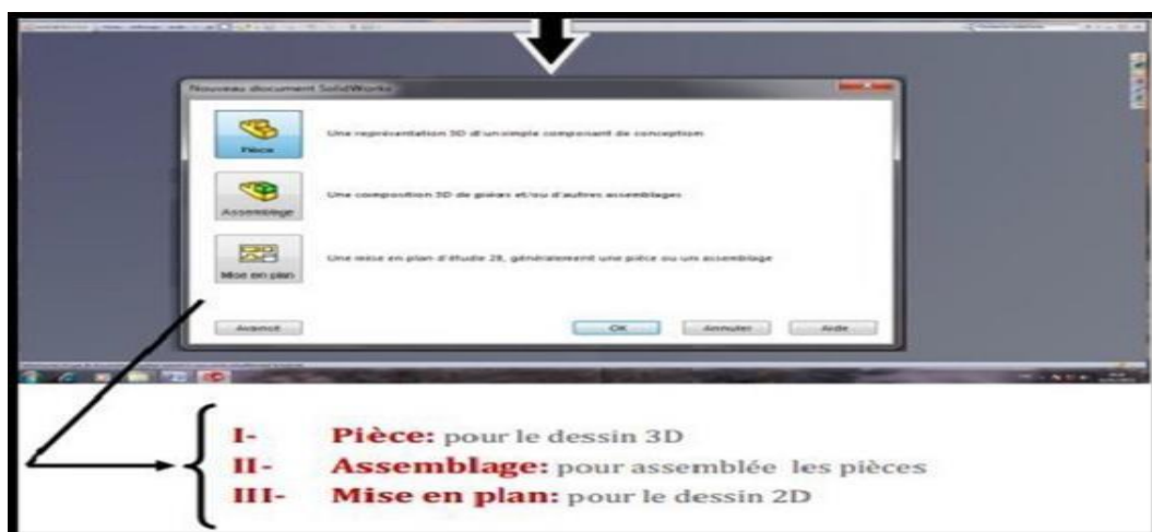
Figure 2.1 : Créer ou ouvrir un fichier SOLIDWORKS[9]
