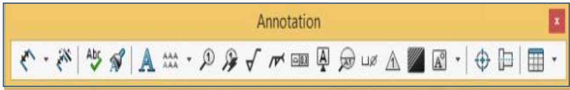
Figure 2.9 : La barre d'outils d'annotation permet d'insérer des cotes diverses[8]
