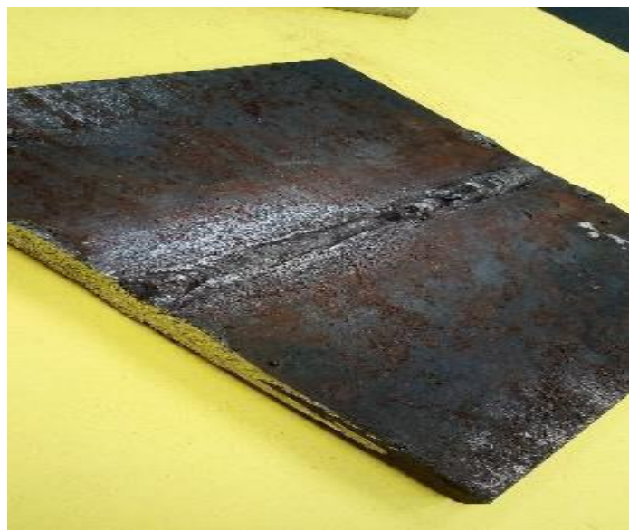
Figure IV.4 :tôle après soudage
