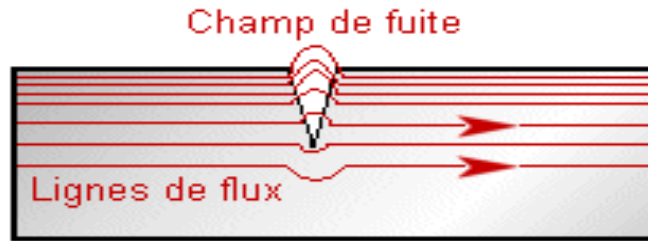
Figure III.32 : principe de contrôle par magnétoscopie
