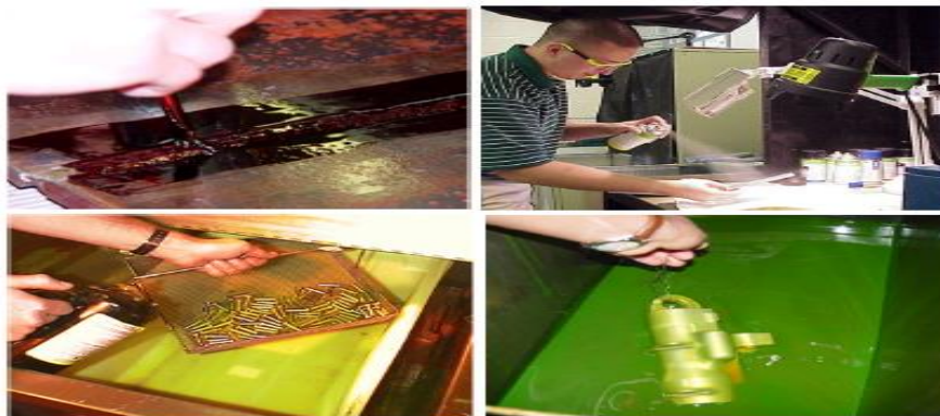
Figure III.17 : application du pénétrant
