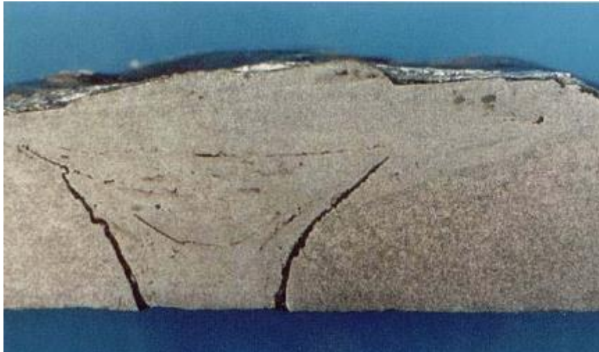
Figure II.8: fissure à froid
