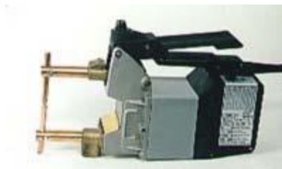
Figure I.14 : machine à souder par résistance avec pinces
