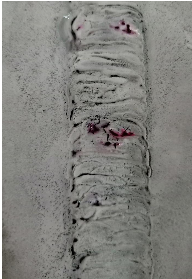
Figure IV.21 : résultat de Contrôle par magnétoscopie.
