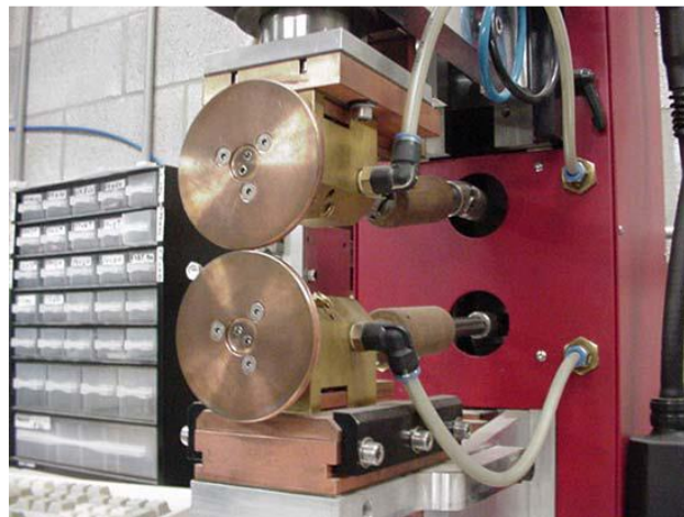
Figure I.15 : machine à souder par résistance à la molette
