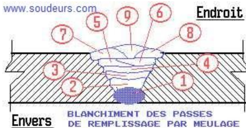
Figure III.51 :réparation des passes de soudage
