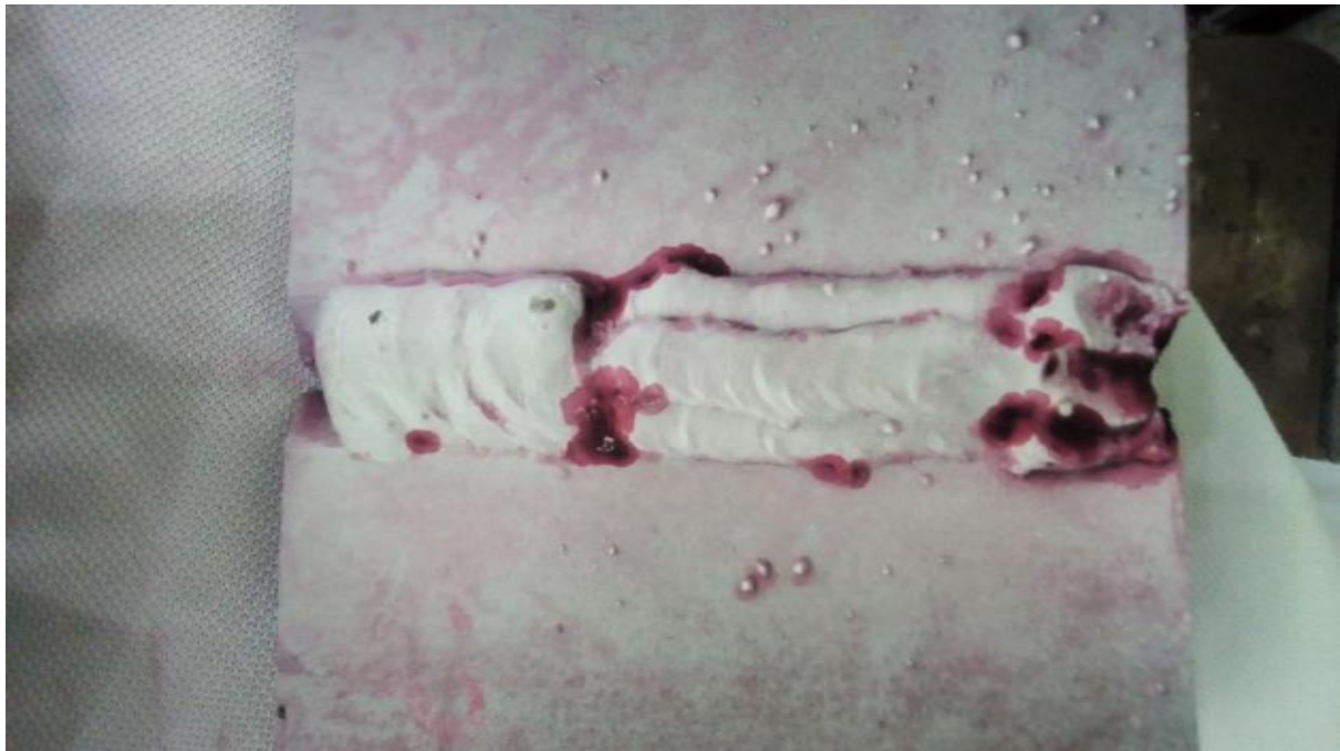
Figure IV.14. 15 : résultat de Contrôle par ressuage.
