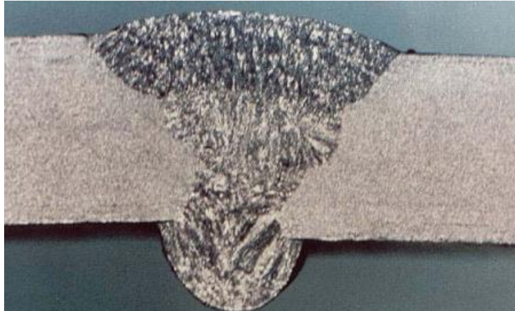
Figure II.17: effondrement et excès de pénétration
