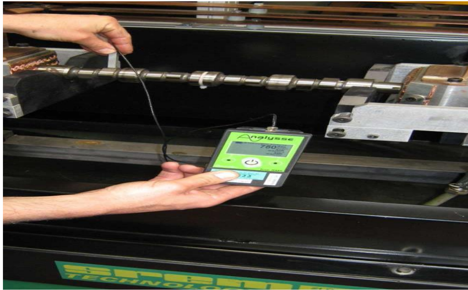
Figure IV.16 : Mesureur numérique de champ magnétique tangentiel affichant simultanément les valeurs : moyenne, crête vraie et efficace vraie
