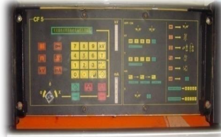
figure III.40 générateur de haute tension
