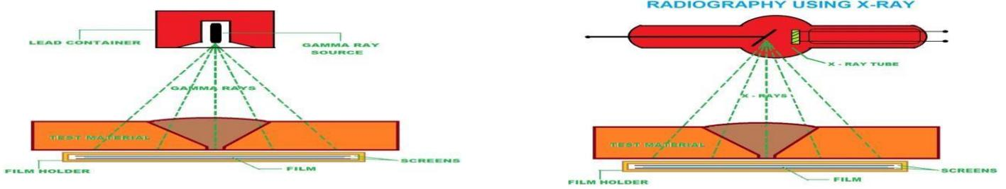
Figure II.22 : le principe de radiographie [14].
