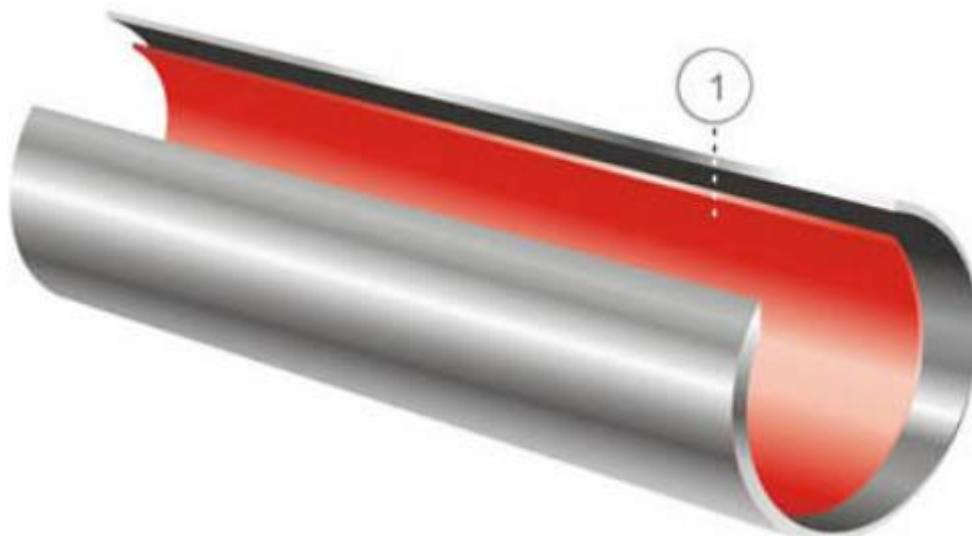
Figure II.9 : Revêtements en résine époxy liquide pour les pipelines [10].
