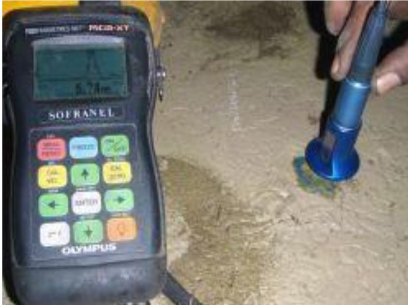
Figure IV.12 : Le mesureur d'épaisseur
