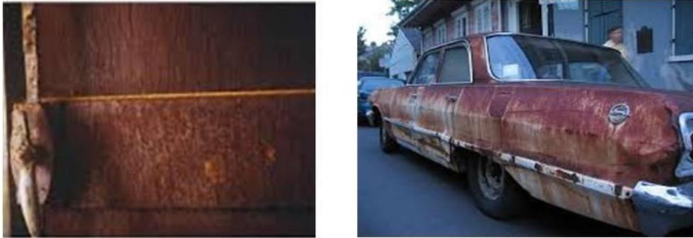
Figure III.4: Corrosion généralisée : exemple d'une porte et d'un véhicule corrodés [15].
