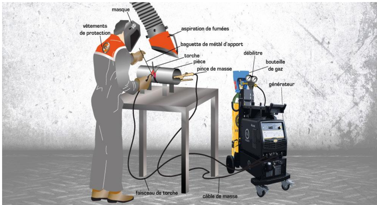
Figure II-2 : l'équipement de soudage TIG [29].
