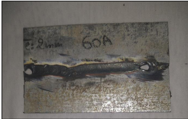
Figure III-16 : soudage de plaque pour 2mm d'épaisseur avec 60A.
