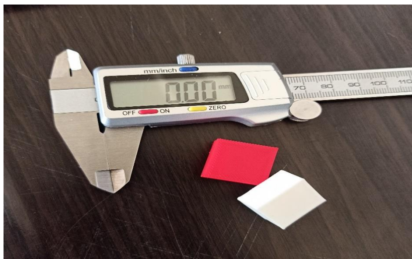
Figure III- 31 : contrôlé les hauteurs avec un pied à coulisse
