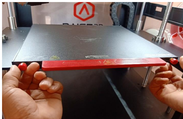
Figure III- 4 : Fixation de la plaque d'impression
