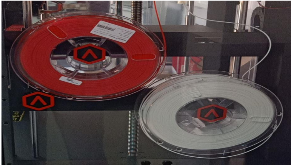
Figure III- 8 : Montage correct des bobines du matériau
