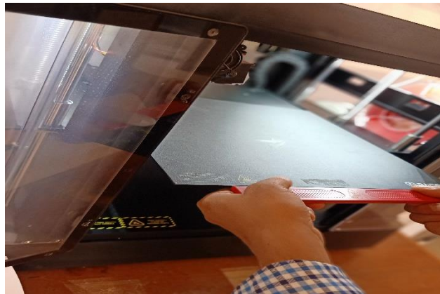
Figure III- 3 : Montage de la plaque d'impression
