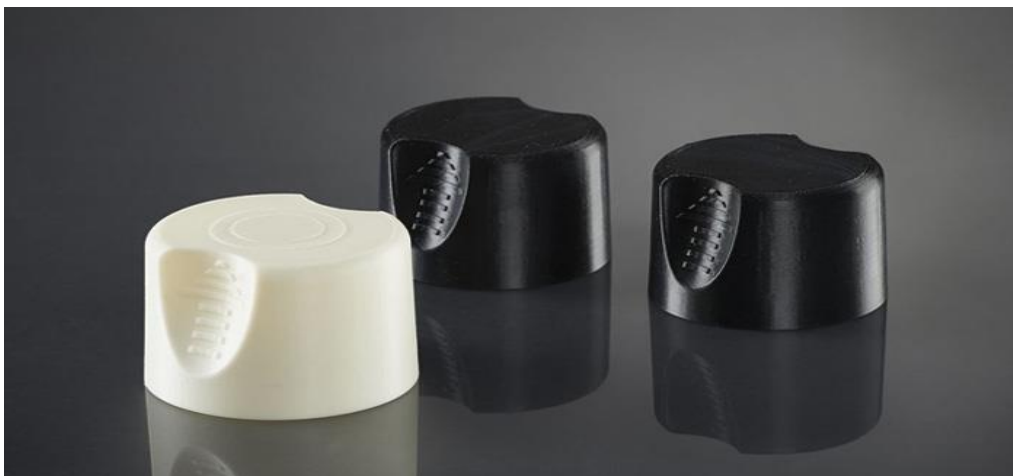
Figure I- 17 : Exemples de pièces ASA imprimées [3]
