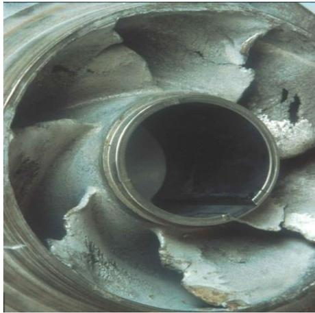
**Figure I. 4** *L'effet de la cavitation sur une pompe centrifuge.*
