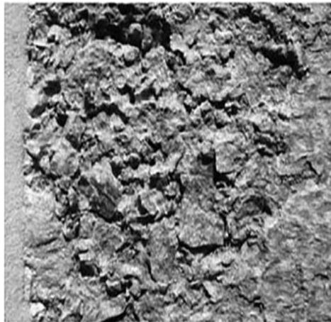
**Figure I. 7** *Détérioration de pièces mécanique soumises à une exposition prolongée à la cavitation.*
