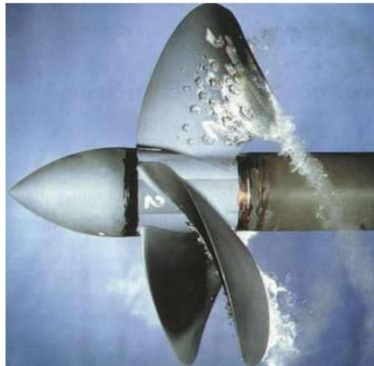
**Figure I. 6** *Apparition de bulles de cavitation sur les pales d'une hélice.*
