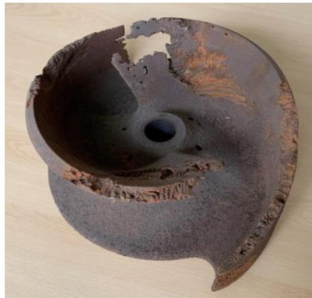
**Figure I. 3** *L'effet de la cavitation d'une pompe de relevage.*
