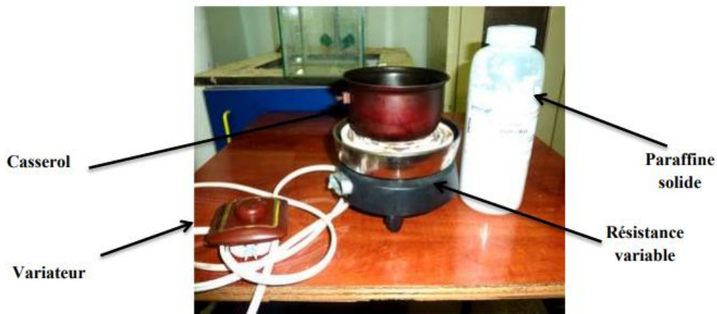
Fig. 3.7. Chauffage de la paraffine.
