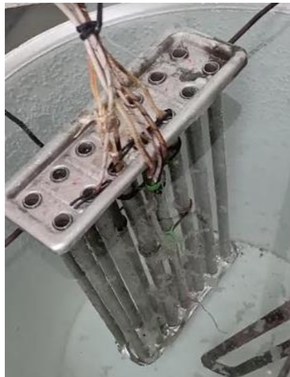
Fig. 3.6. Tubes utilisés en forme de U
