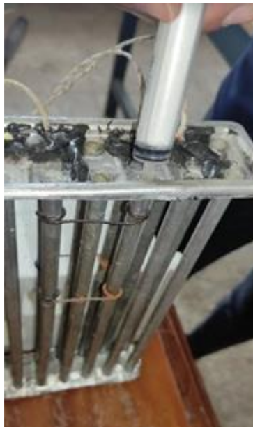
Fig. 3.8. Remplissage des tubes par la paraffine
