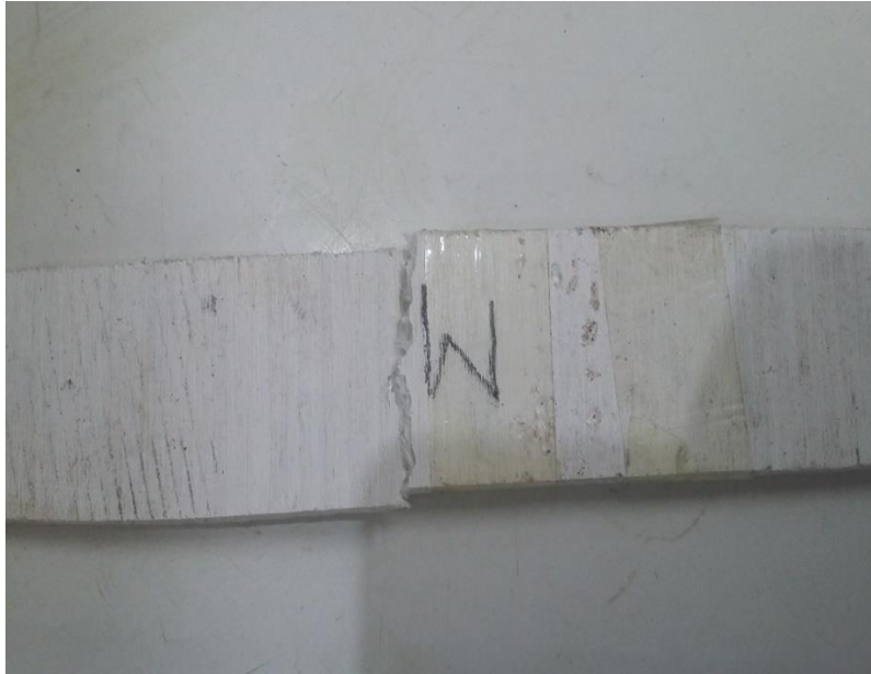
Figure III- 3: Epreuve de mat après la rupture
