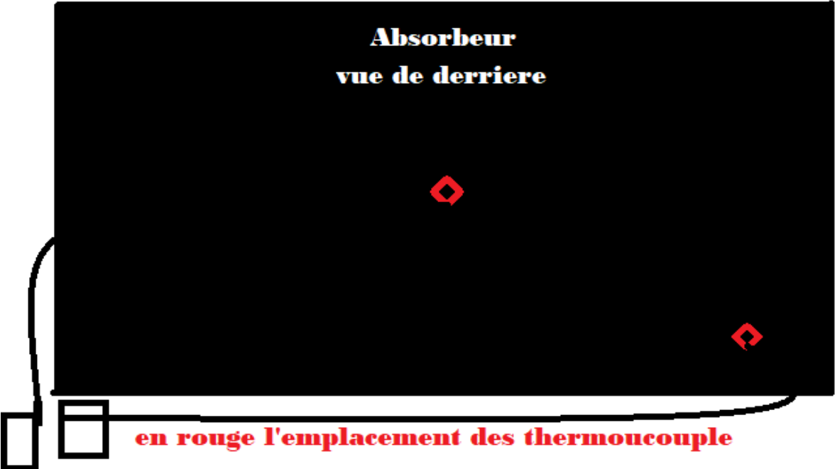
Figure 25 : l'emplacement des capteurs sur l'absorbeur
