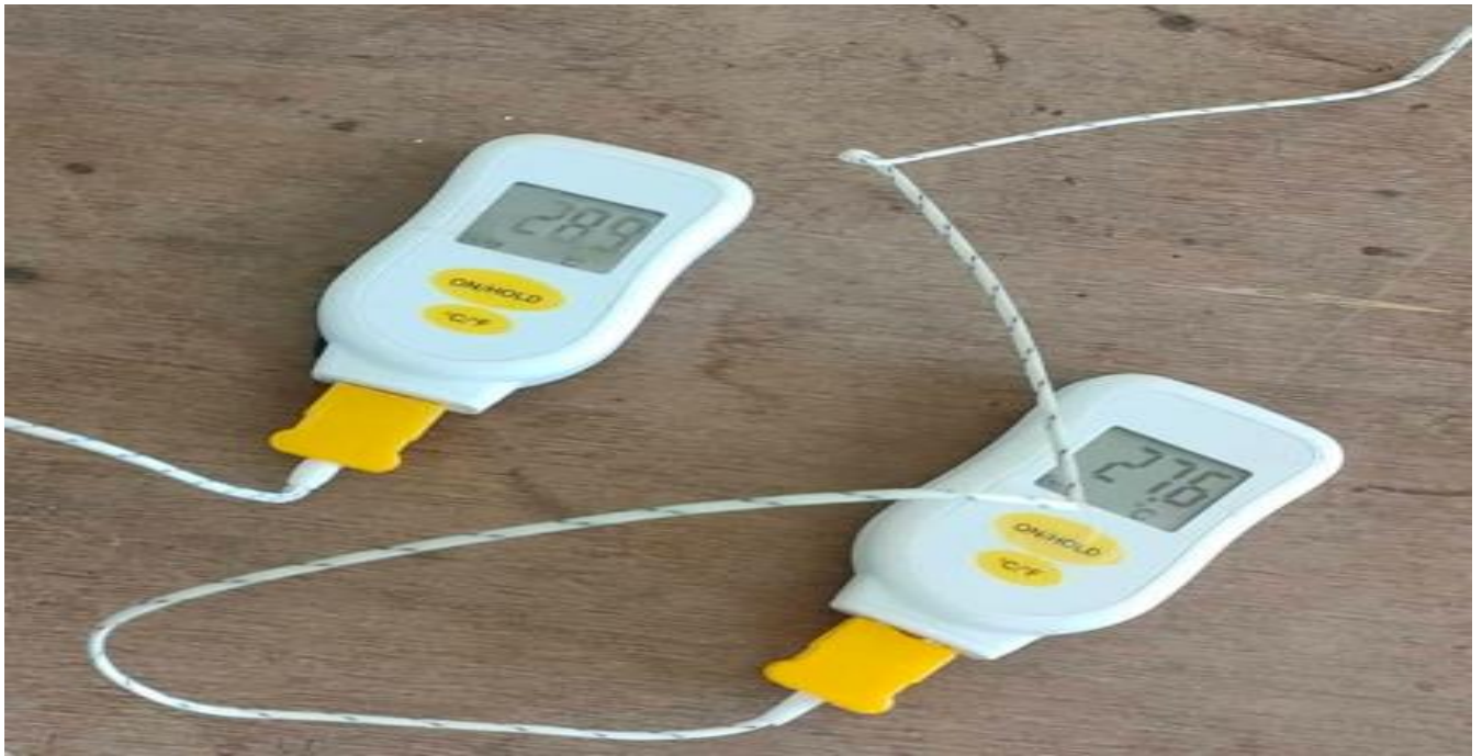
Figure 23 : Capteurs de type K utilisé au cours de l'expérience
