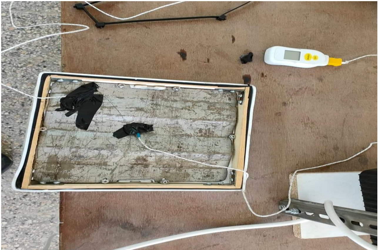
Figure 27 : Emplacement des capteurs de température dans l'absorbeur
