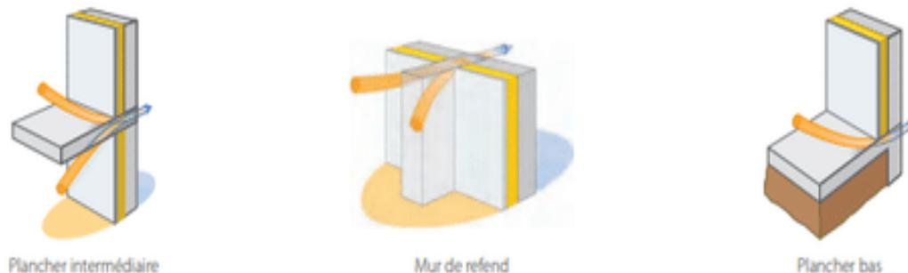
*Figure 6 Ponts thermiques de liaison*
