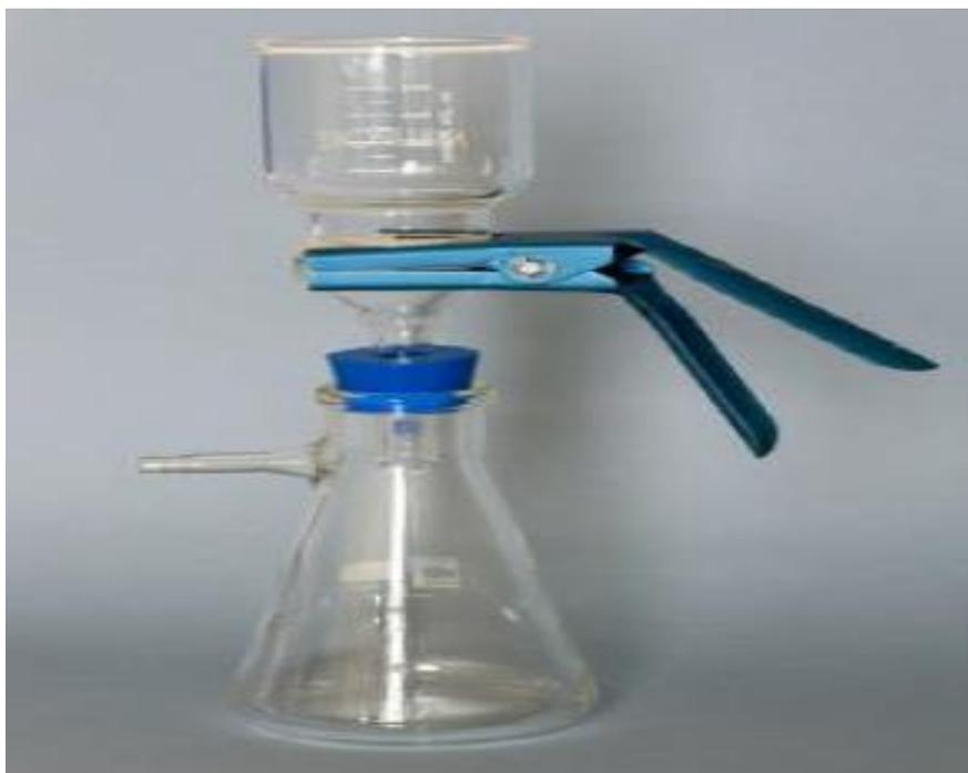
Figure IV.2 : Dispositif de filtration
