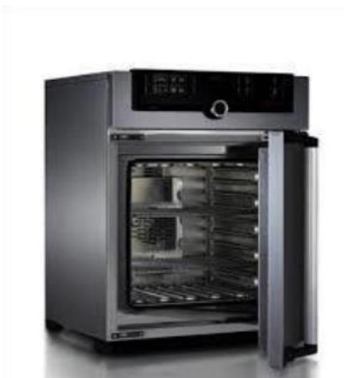
**Figure IV.5 :** Photo de l'étuve de séchage
