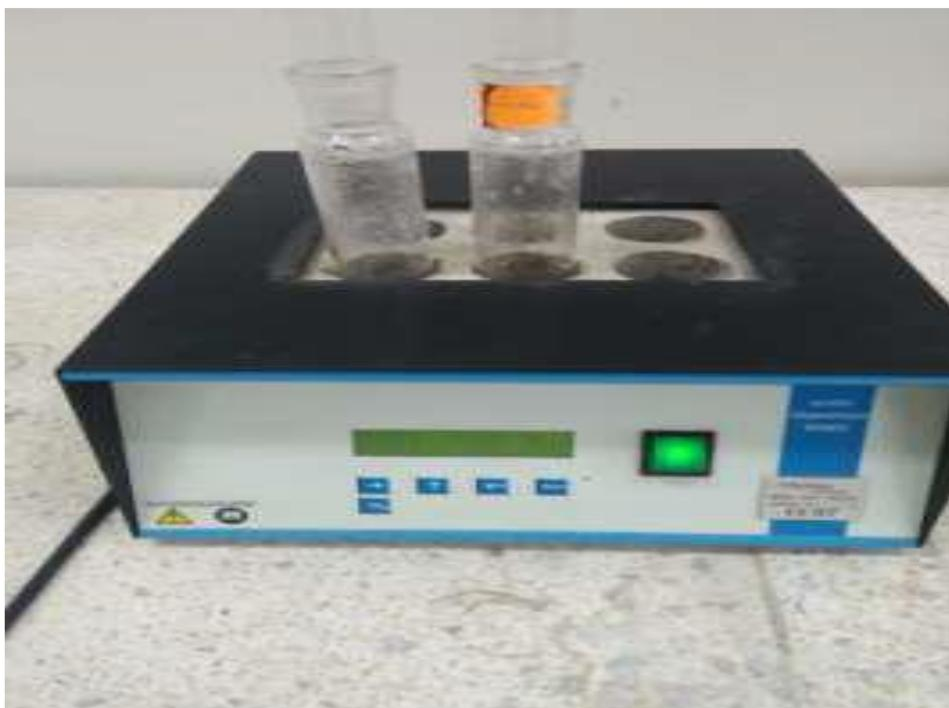
**Figure IV.8** : Photo du digesteur (réacteur DCO pour le chauffage)
