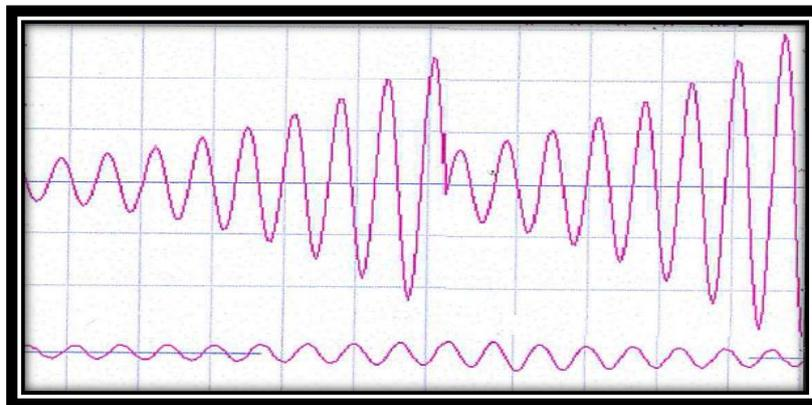
Figure III.21 : Signal démodulé de l'information  $[Z + \Delta Z]$
