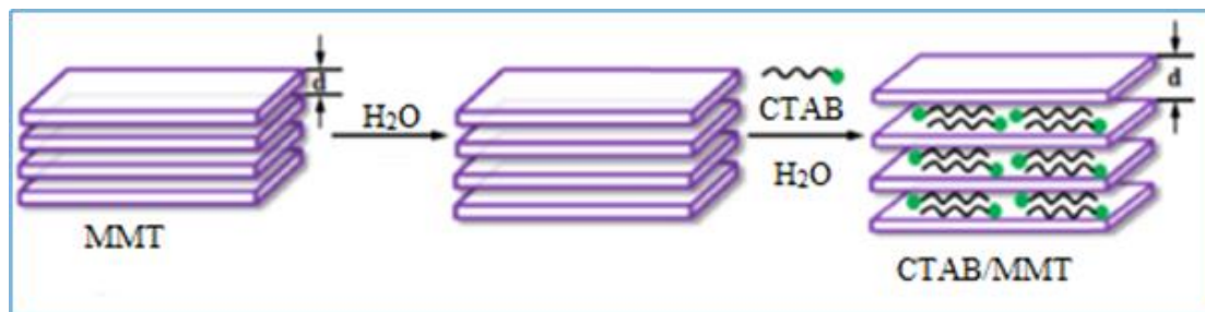
Figure 4 : La procédure de modification de la bentonite par CTAB [47].
