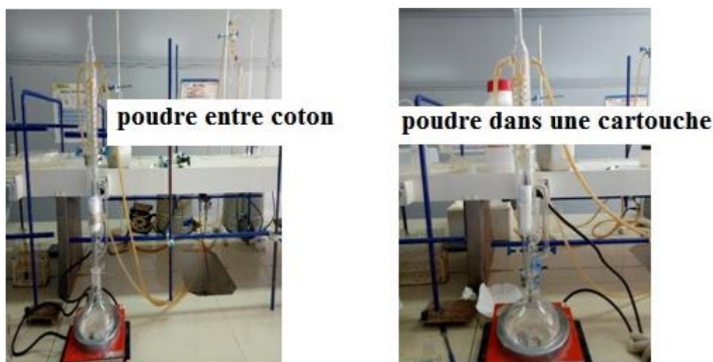
Figure 18 : Montage Soxhlet utilisé par deux méthodes d'introduction de la poudre.
