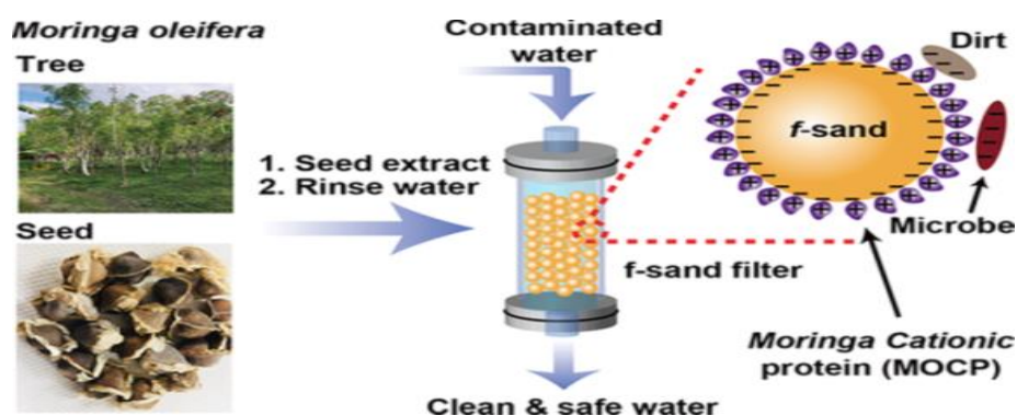
Figure7 : Filtre à sable fonctionnalisé à l'extrait de graine de Moringa (sable f) pour amélioration de l'élimination des agents pathogènes 14 .
