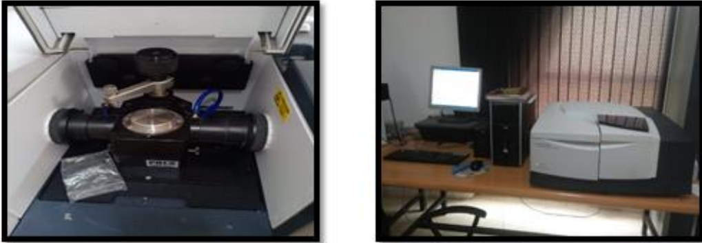
Figure II.11 : Appareil spectromètre FTIR à transformée de Fourier.
