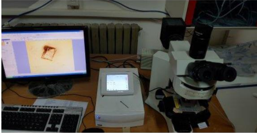
Figure (III.1) : Dispositif expérimental utilisé pour l'étude du gonflement des réseaux de copolymères dans le cristal liquide 5CB.
