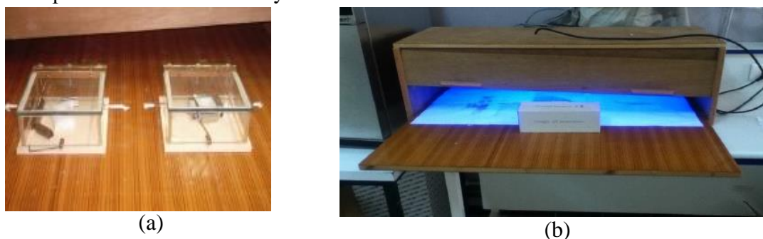
Figure (II.1) : Dispositif expérimental utilisé pour la photo-polymérisation UV ; (a) Chambre contenant l'échantillon, (b) Dispositif complet avec lampe UV.
