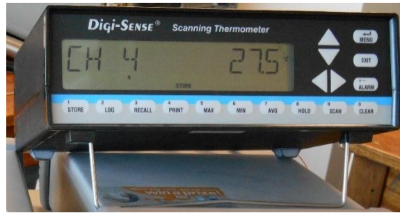
Figure 3.27 : Thermomètre à balayage pour la mesure la température à l'aide de thermocouples (type Digi-Sense).
