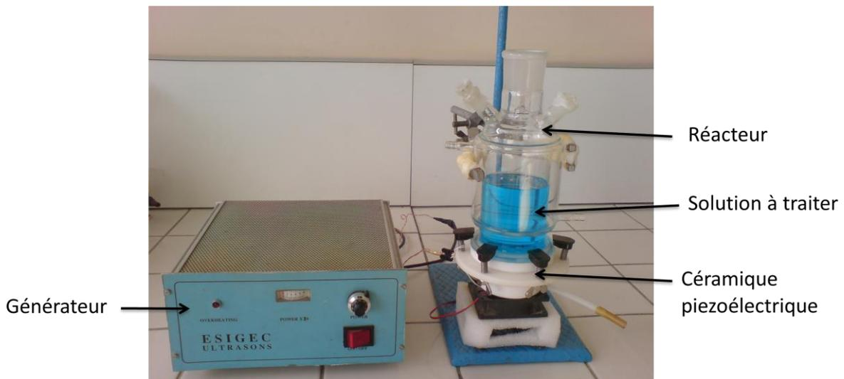
**Fig. II-2:** Dispositif pour les procédés ultrasonores
