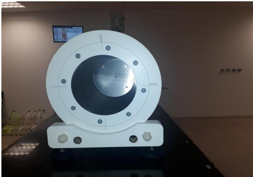
**Figure 32: Fantôme Arc CHECK sans bouchon de cavité**
