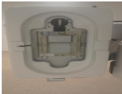
Figure V.14 : Emplacement du filtre half fan sur le KVS [4].
