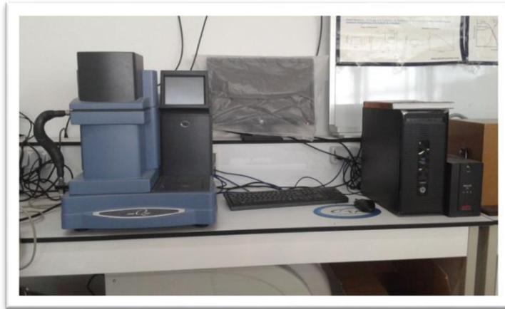
**Figure II.15 :** la DMA Q800 TA.
