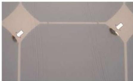
Figure I.16 Modules présentant des points chauds sur les bords des coins Supérieurs [16].
