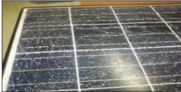
Figure I.15 Dégradation de module photovoltaïque par des bris de verre [6].
