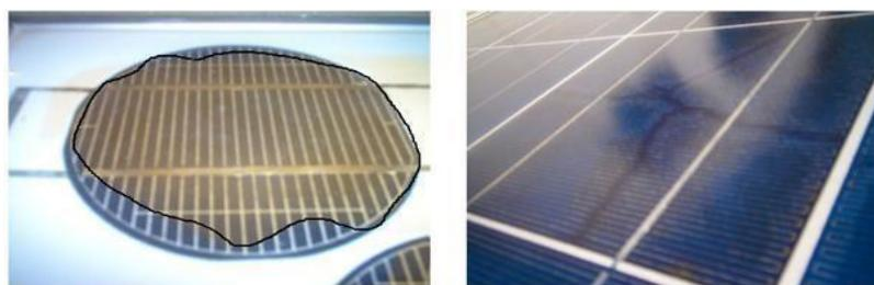
Figure I.14 Modules photovoltaïques avec des cellules décolorées [13].
