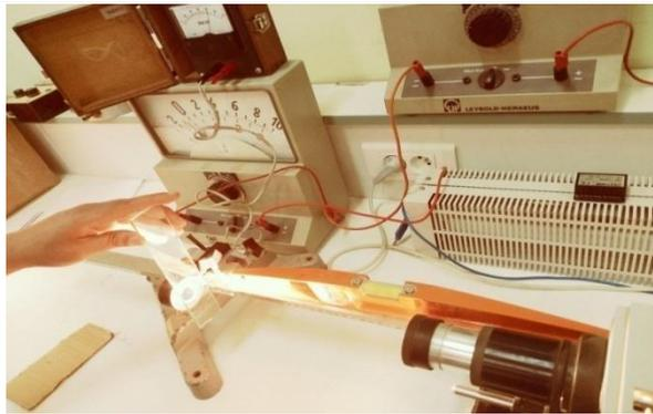
Figure III.04 Effet de la poussière sur l'éclairement.
