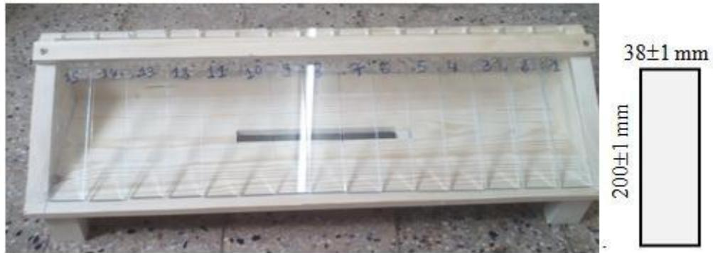
Figure III.01 Présentation du support et la dimension des pièces de verre
