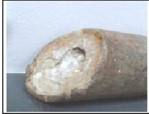
**Photo. 8 :** *Carbonate de Calcium ( $\text{CaCO}_3$ ).*    **Photo. 9 :** *Sulfate de Strontium ( $\text{SrSO}_4$ ).*
