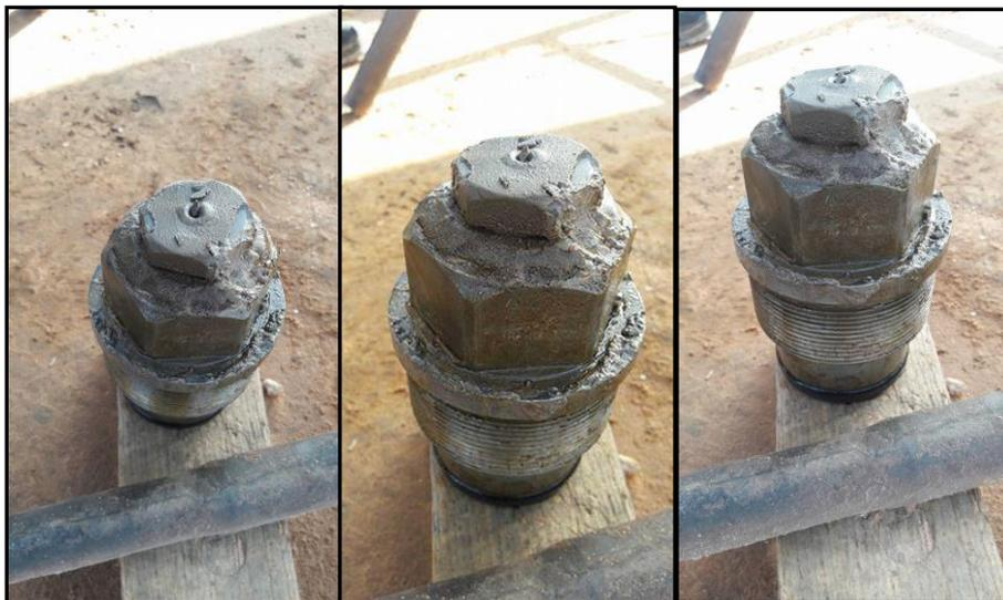
*Photo. 3 : Dépôt formé au niveau de la buse du puits BKP2 de la région HBK.*
