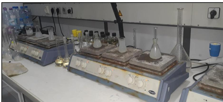
**Fig.63**: Teste d'efficacité du produit 'C' sur le mélange (Eaux de gisement BKP2 / Eau d'injection de l'Albien (J-202)).
