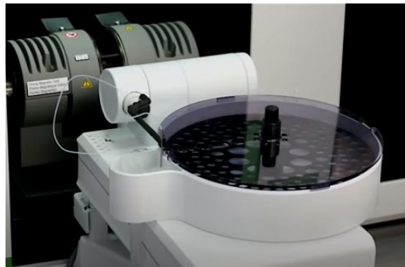
Figure 21 : Photo d'échantillonneur automatique d'un spectromètre AA 413
