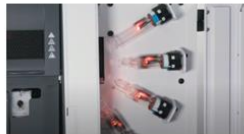
Figure 14 : Photo d'une LCC placée dans un spectromètre AAFG 410
