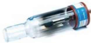
Figure 14 : Photo d'une LCC placée dans un spectromètre AAFG 410
