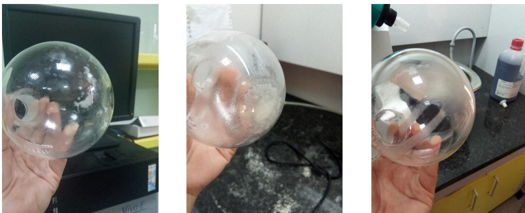
Figure 33 : Le film lipidique formé à des vitesses de rotation élevées
