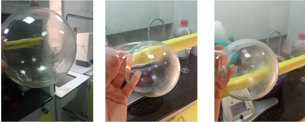
Figure 34: Le film lipidique formé à une vitesse de rotation de 110 tr/min.
