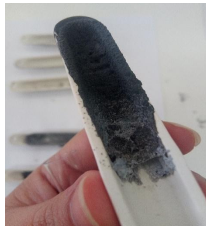
Figure 39 : Echantillons après calcination à 500 °C pendant 1h
