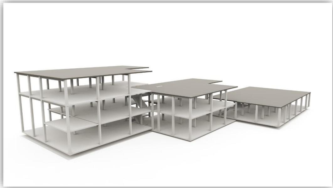
**Figure 70:** Système structurel poteaux poutres de la partie Incubateur, **Source :** auteur
