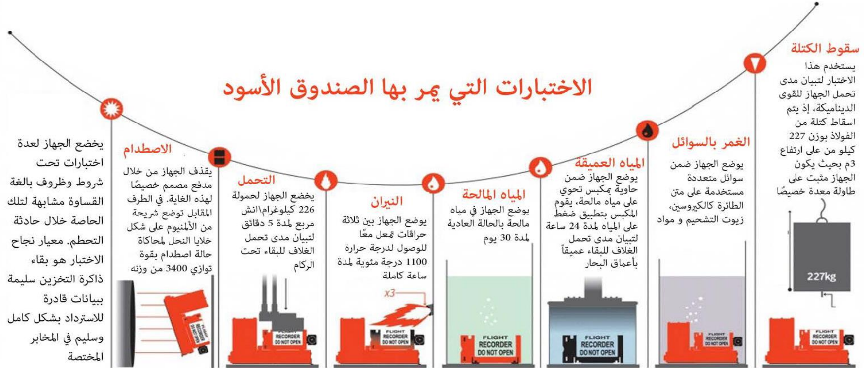
صورة 14: الإختبارات التقنية التي يمرّ بها الصندوق الأسود لتحديد متانته.
