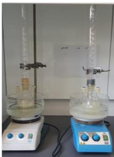
**Figure 3: montage employé dans la synthèse des chalcones par agitation magnétique.**
