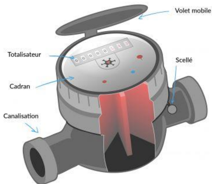
Figure 2.8. : Présentation de fonctionnement d'un compteur mécanique [16]
