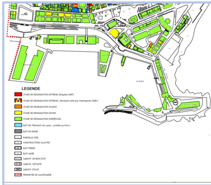
Figure 11 Carte état du bâti. 42 .
