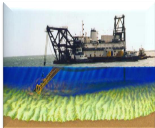
(a) Drague aspiratrice stationnaire avec conduite de refoulement
