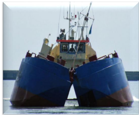
(c) Dragage suceuse autoporteuse (fendable)
