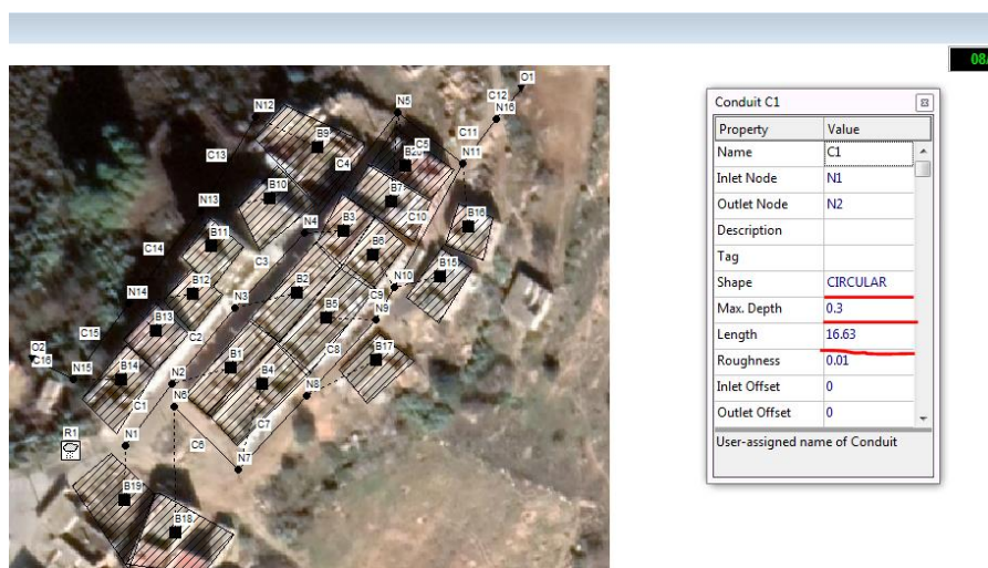
Figure IV.7 : Ecriture des données des conduits
