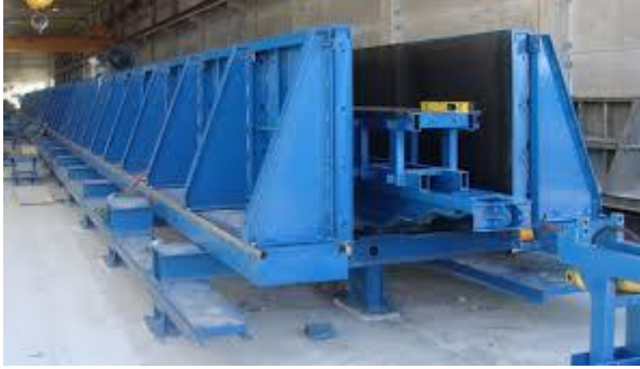
Figure1 : Moules pour éléments préfabriquées en béton
