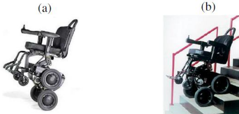
Figure 1. 8 : a) : IBOT en position de deux roues (b) : IBOT en position de descente d'escaliers
