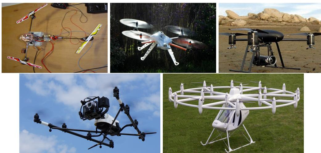
FIGURE 1.17 – (a) trirotor - (b) quadrotor - (c) X6 Draganflyer - (d) Falcon 8 - (e) volocopter VC200.
