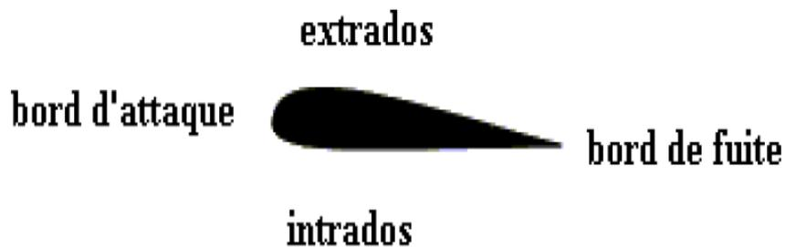
**Figure- II.3** : Profil d'une pale éolienne
