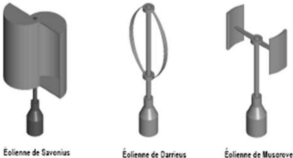
Figure I-4: Exemples d'éoliennes à axe vertical [6]
