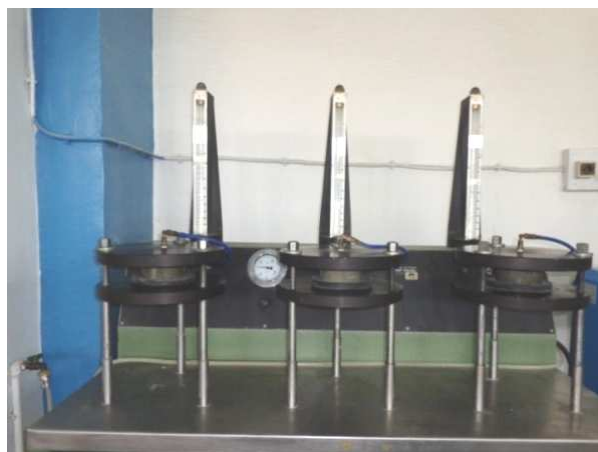
Fig. III-13. Perméamètre à l'eau (Laboratoire EOLE).
