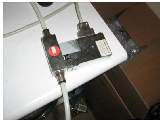
Fig. III-8. Débitmètre massique du gaz (Capacité : 2 l/minute).
