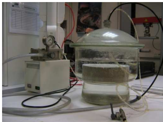
Fig. III-6. Dispositif de saturation.
