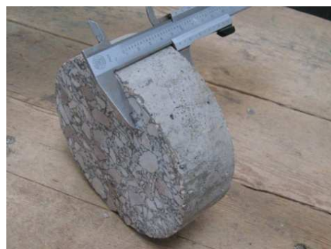
Fig. III-2. Mesure de la hauteur de l'échantillon à l'aide d'un pied à coulisse.
