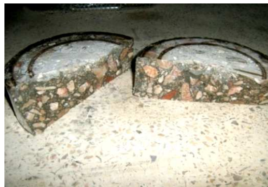
Fig. III-15. Profondeur de pénétration de l'eau à travers un échantillon (15 x 5) cm du béton B35.
