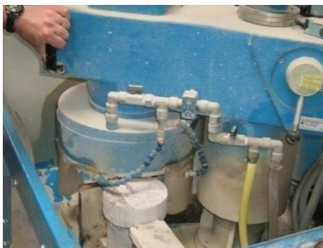
Fig. III-1. Rectification des surfaces planes du disque en béton.
