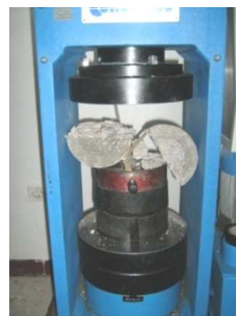
Fig. III-12. Fendage d'une éprouvette du béton (Laboratoire EOLE).
