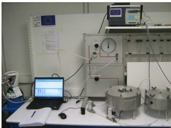
Fig. III-7. Vue générale de perméamètre CEMBUREAU (IUT St-Nazaire).
