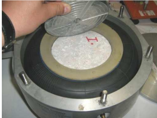
Fig. III-10. Emplacement de l'échantillon de béton dans la cellule de perméabilité CEMBUREAU.
