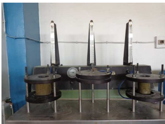
Fig. V-23. Essai de perméabilité sur deux échantillons de différents diamètres.
