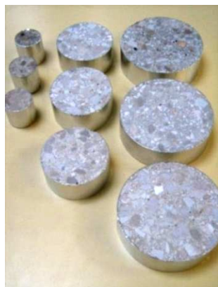
Fig. III-3. Echantillons de béton de différentes tailles (5, 11 et 15 cm de diamètre).
