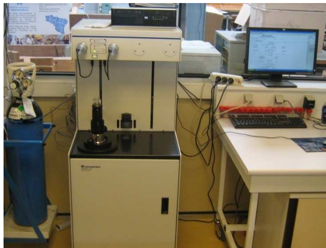
Fig. F-1. Dispositif de mesure de la porosité par intrusion de mercure (IUT de St-Nazaire).
