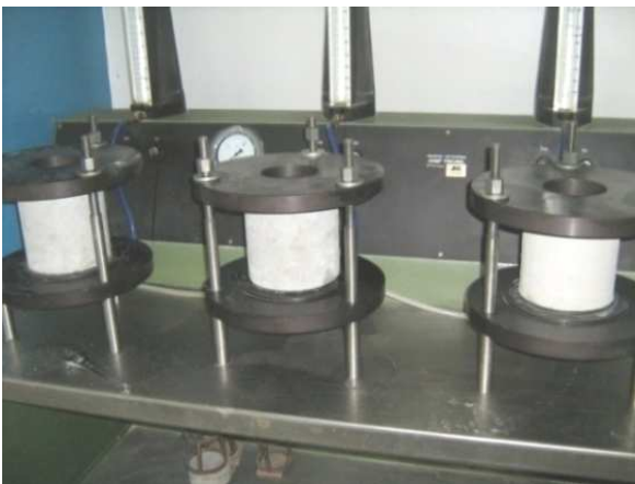
Fig. III-11. Essai de pénétration de l'eau dans le béton (Laboratoire EOLE).
