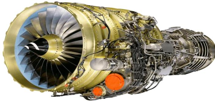
Figure III. 1 :Turboréacteur CFM56-7B
