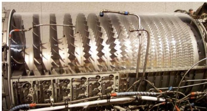
Figure I. 15 : Compresseur axial
