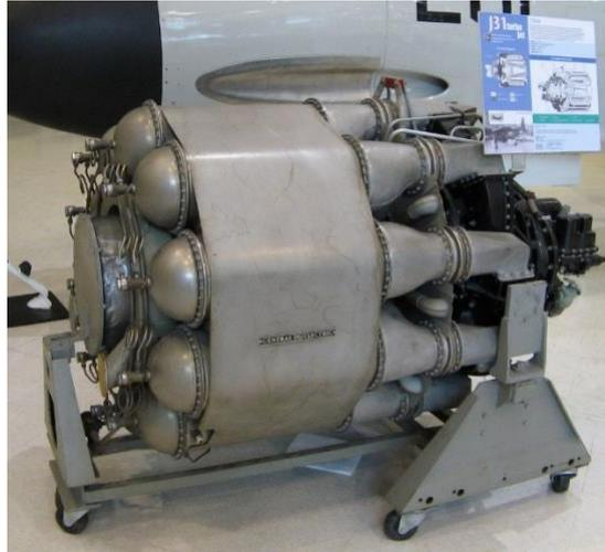
*Figure I. 4 : Modèle J31 de General Electric 1942 [8]*
