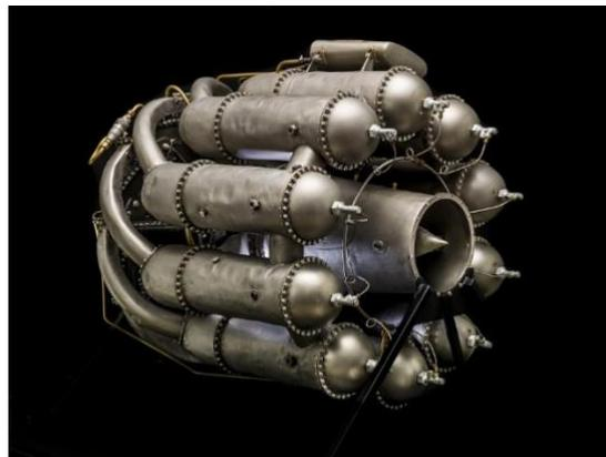
*Figure I. 3 : Le moteur W1 de Whittle 1941 [7]*
