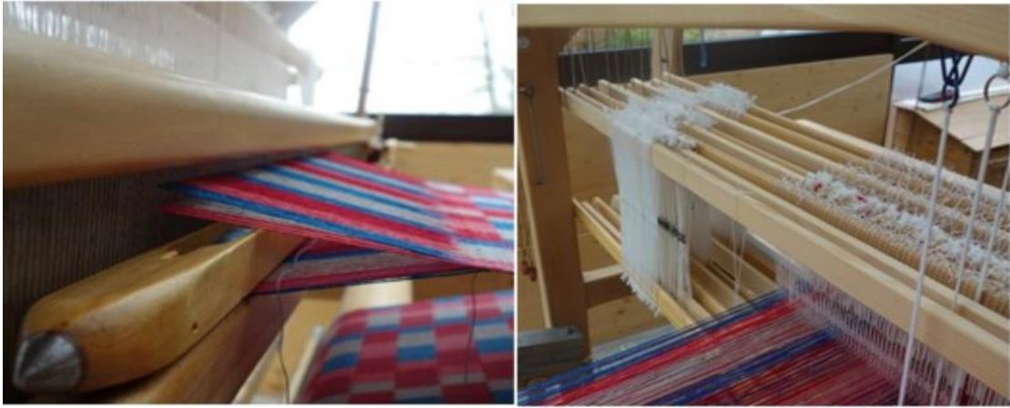
Figure 1. 11 Nappe de chaîne levée pour passer la navette Figure 1. 12 Série de 8 cadres
