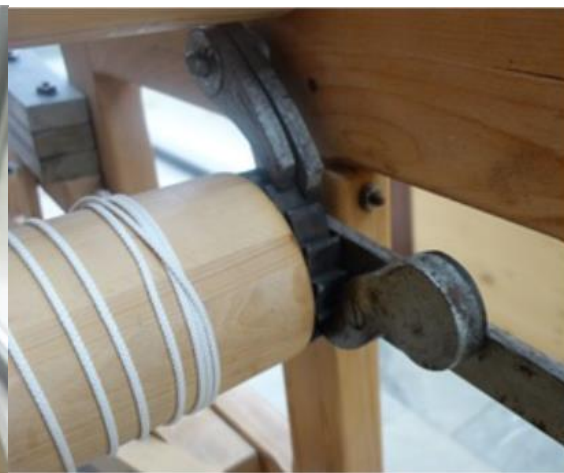
Figure 1. 10 Roue crantée et loquets de blocage
