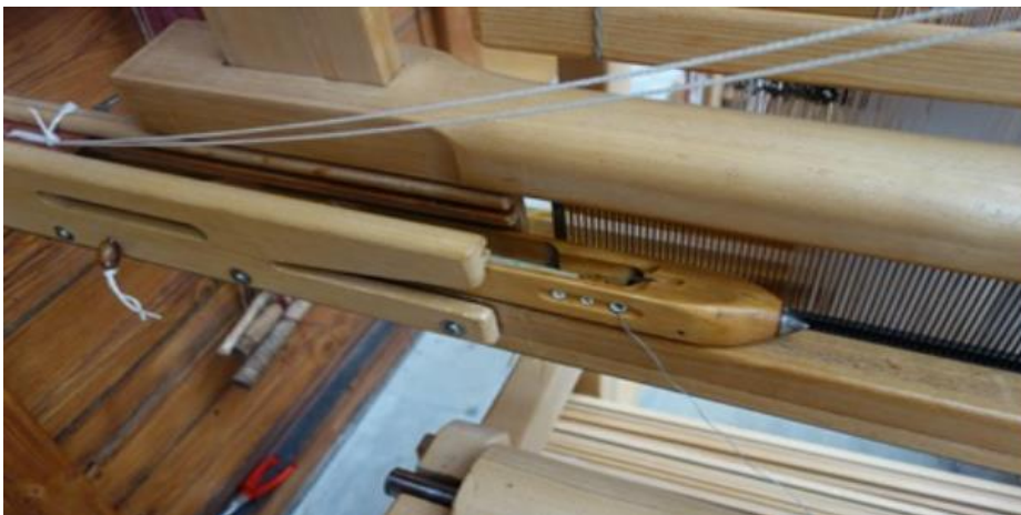
Figure 1. 13 Battant de peigne muni d'un chasse-navette
