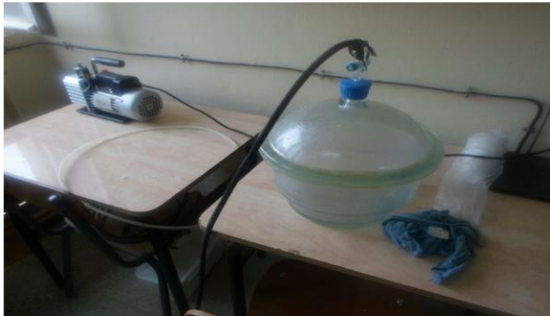
Figure 3. 18. Équipements de mesure de la porosité accessible à l'eau (El Bahi et al., 2016)
