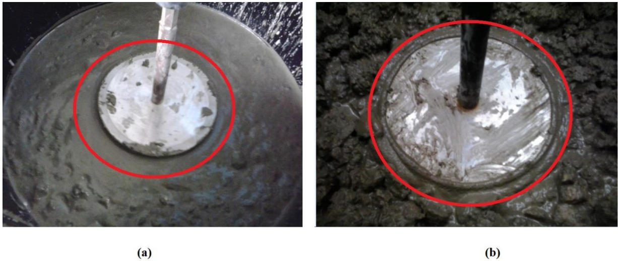
Figure 4.9. Aspect visuel des couches lubrifiantes formées au cours d'un essai tribologique (a) béton fluide (b) béton ferme
