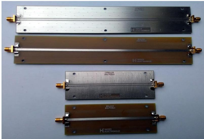
Figure I 13: exemples de deux microstripline avec des longueurs différentes en réalité
