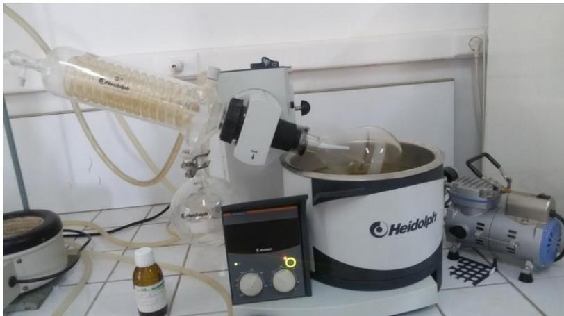
**Figure 04 :** Photographie du Rotavapor utilisé.
