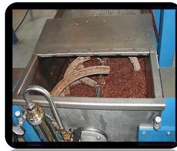
**Figure 07** : broyeur à marteau
