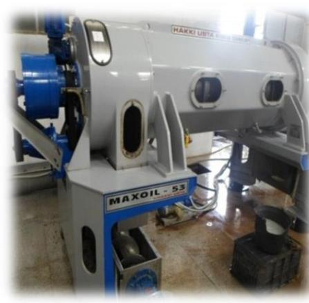
**Figure 15** : décanteuse à trois phases
