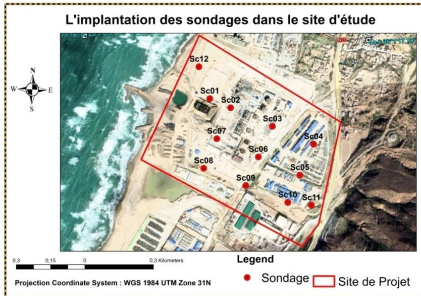
Figure 4. 2 L'implantation des sondages dans le site d'étude.
