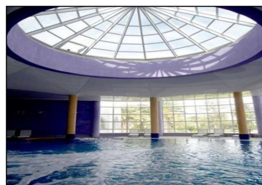
Fig.181 : Exemple d'éclairage zénithal
