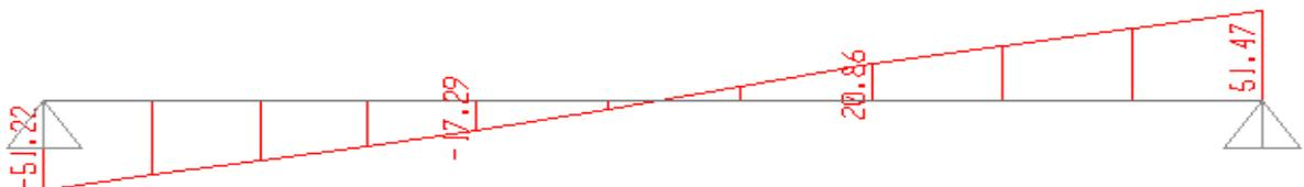
Figure III. 14 : Diagramme des efforts tranchant d'escalier type03 - volée 2 à l'ELU
