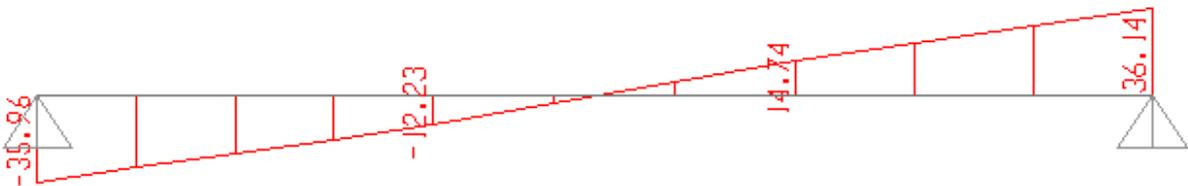
Figure III. 16 : Diagramme des efforts tranchant d'escalier type 03 - volée 2 à l'ELS
