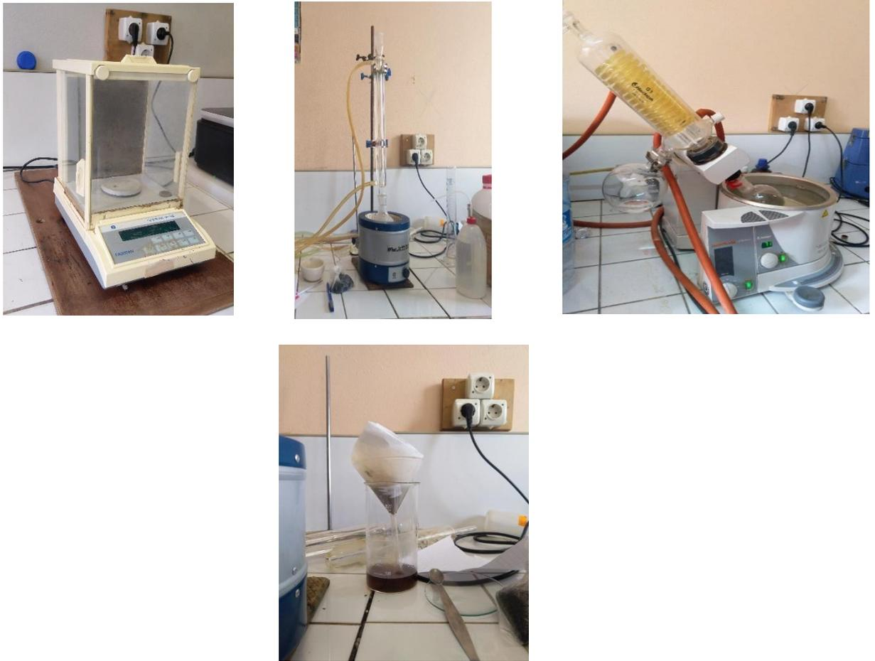
**Figure 11** : Photographie du matériel utilisé lors des processus d'extraction par décoction au laboratoire (respectivement : la balance à précision ; le reflux ; le rota-vapeur à réfrigération ; processus de filtration)
