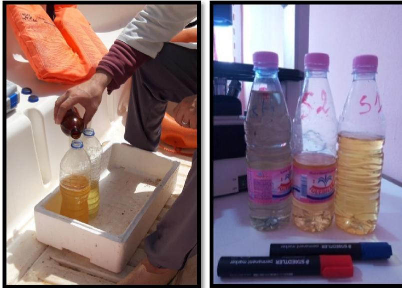
**Figure 18:** photo de la fixation au Lugol et l'étiquetage de l'échantillon(**originale**).
