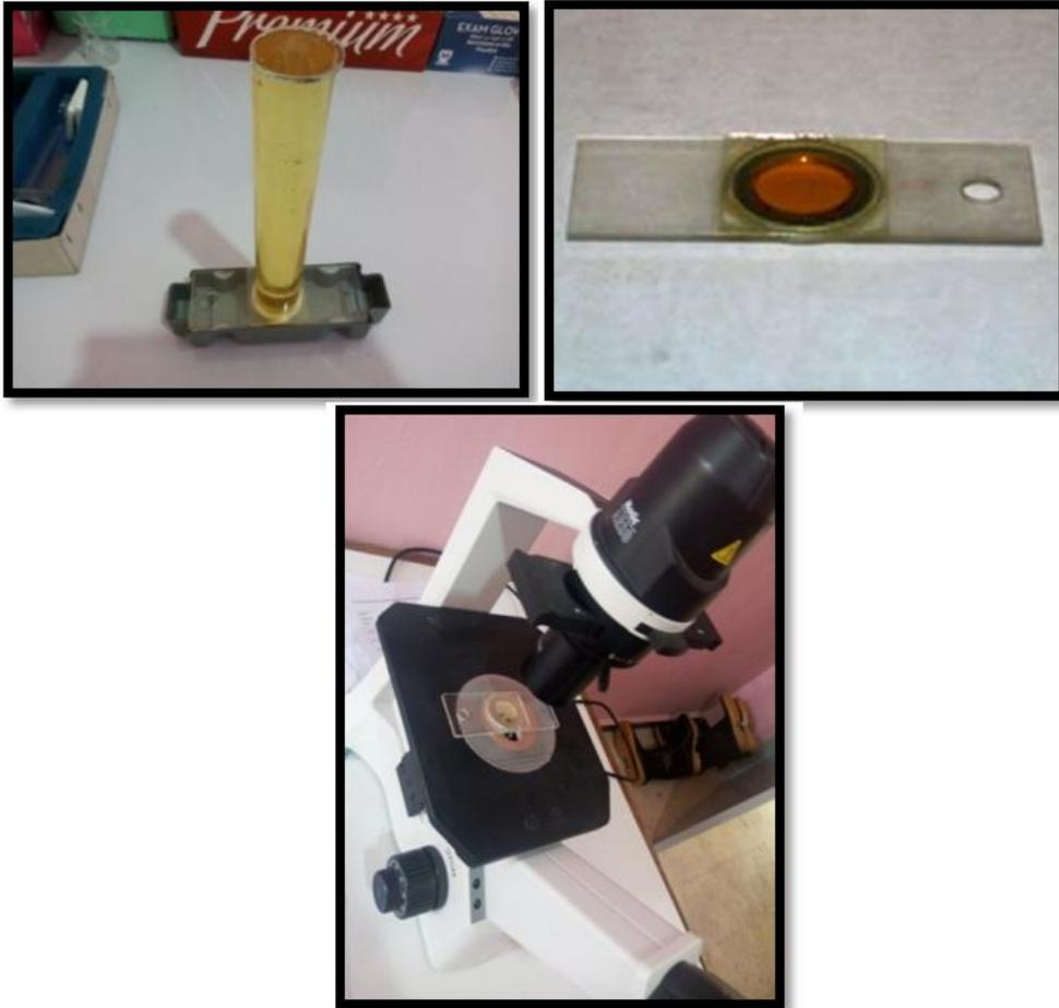
**Figure 2:** photographies présentent la chambre de décantation, la lame d'observation et le microscope inversé(**originale**).
