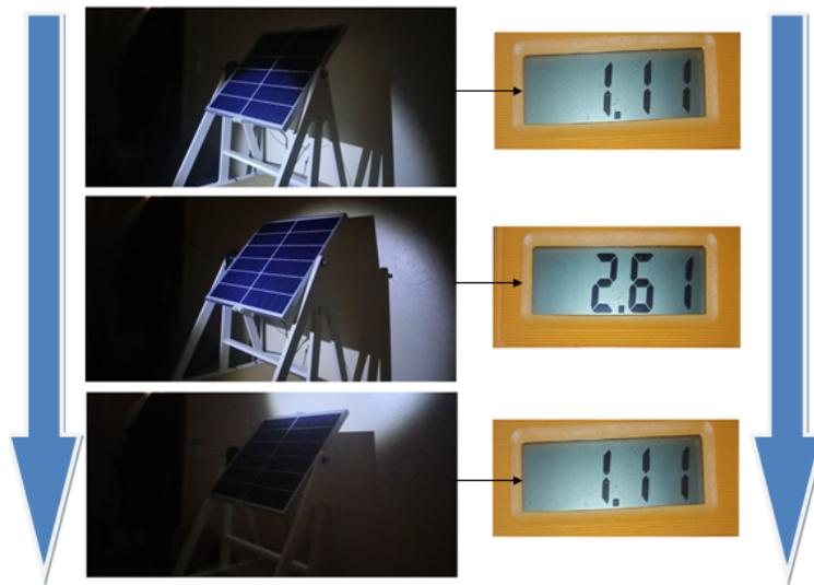
FIGURE II.39 – Essai dynamique panneau fixe 30°
