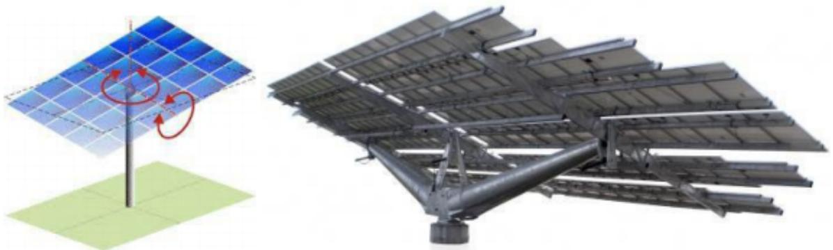
FIGURE I.25 – Suiveurs solaires à double axes
