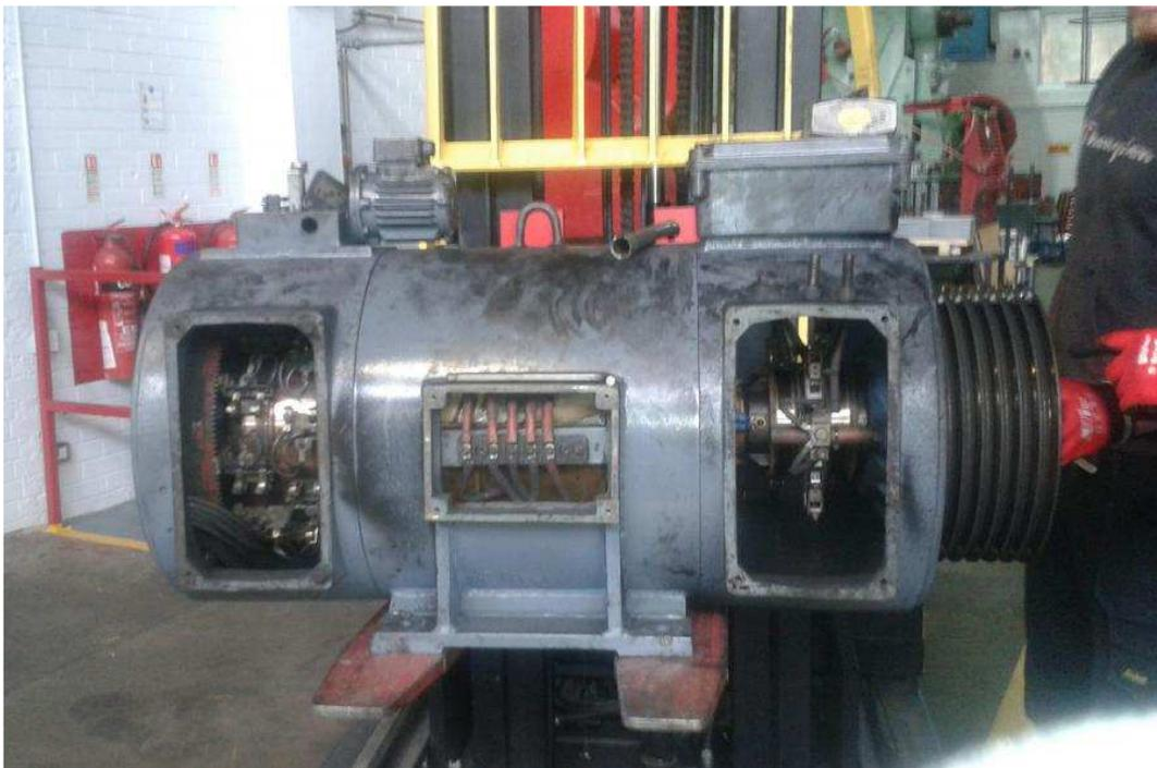
Figure I. 1 : Moteur Schrage [6]
